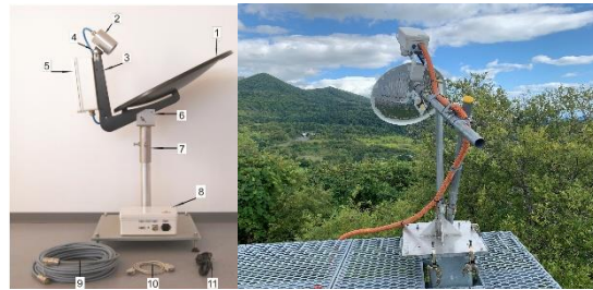
図 1 : 左図は MRR のシステム構成要素 (MRR-2 User Manual, 2013)。右図はアンテナを有珠山頂に向けて観測しているときの様子。
